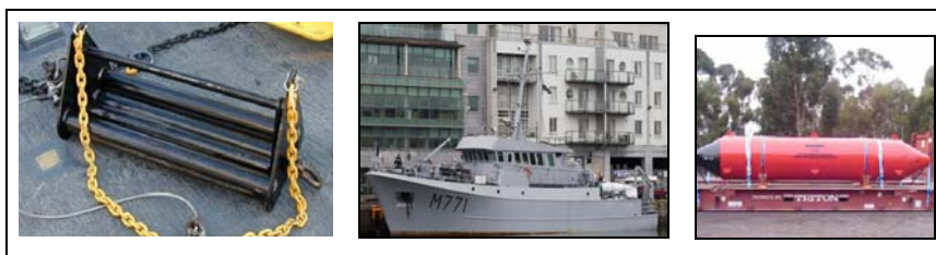
Rys. 6. Francuski trałowiec FNS Alster (centralnie) wraz z zastosowanym podczas prób morskich pod Brestem systemami trałowymi: akustycznym trałem PNM (po lewej) oraz trałem magnetycznym typu DYAD (po prawej)
