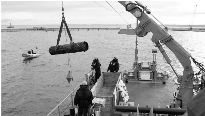
Zdj. 1. ORP Czajka podczas wydobywania miny Mark VI na terenie budowy Gazoportu w Świnoujściu źródło: zdjęcie ze zbiorów autora
