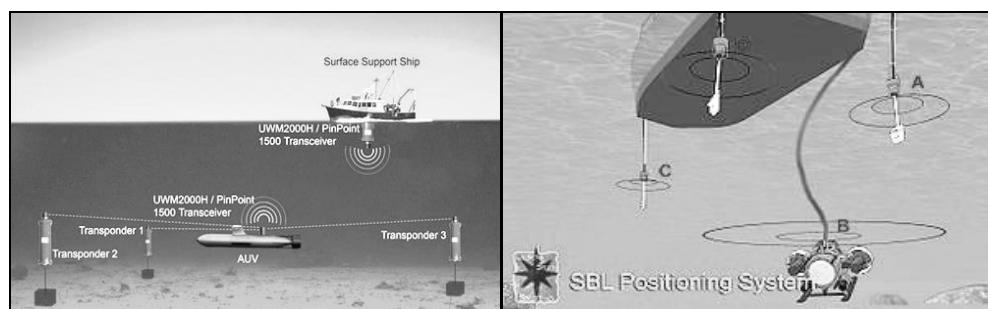
Rys. 1. System pozycjonowania LBL i SBL
