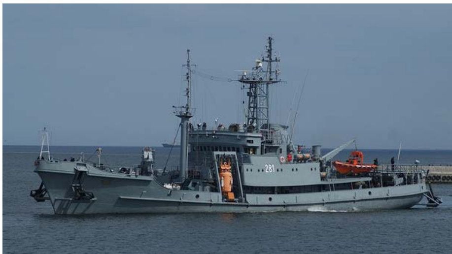
Fot. 3. ORP „Piaś”, okręt ratowniczy projektu 570M. Platforma do realizacji nurkowań głębokowodnych realizowanych w ramach szkolenia żołnierzy uprawnionych do wykonywania prac podwodnych.
