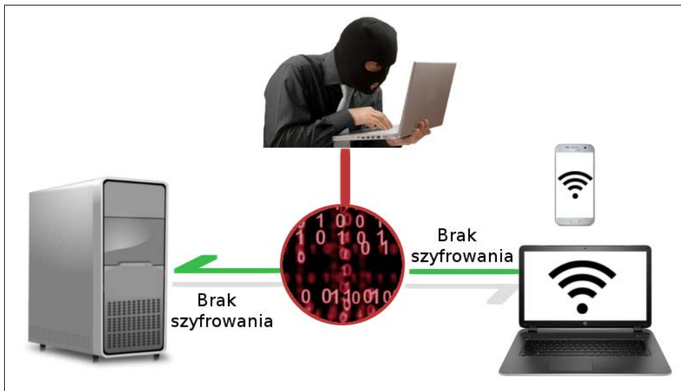
Rys. 2. Zobrazowanie użycia sniffera w otwartym WiFi.
