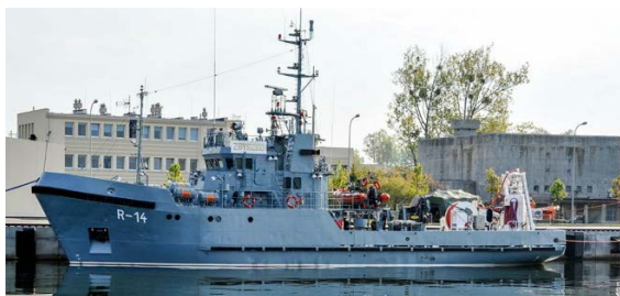
Fot. 5. Kuter ratowniczy projektu 5002: a) ORP „Zbyszko”; b) mobilny system nurkowy z dzwonem mokrym posadowiony na rufie okrętu projektu 5002.
