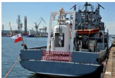
Fot. 5. Kuter ratowniczy projektu 5002: a) ORP „Zbyszko”; b) mobilny system nurkowy z dzwonem mokrym posadowiony na rufie okrętu projektu 5002.
